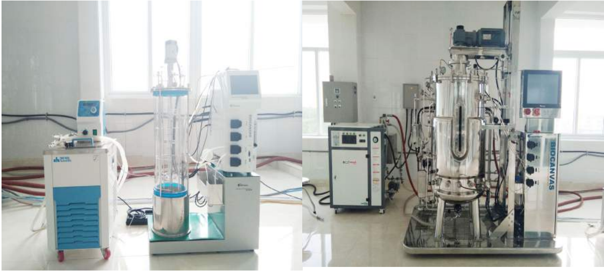
Hệ thống lên men tự động hoàn toàn 15 lít, 300 lít. Ảnh: Mậu Bình
