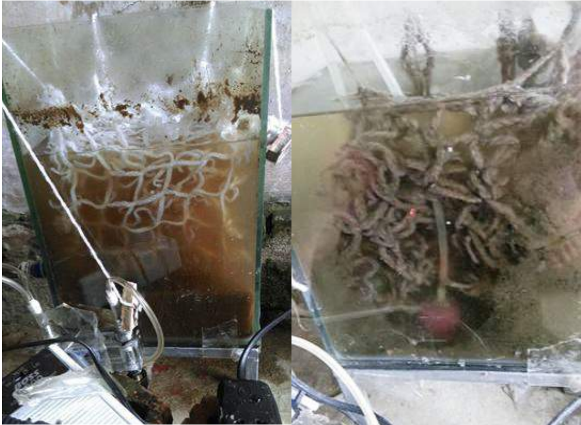
Hình 1. Sợi vật liệu đệm trong bể hiếu khí trước và sau khi đánh bám
