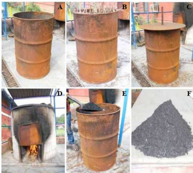
Hình 3. Quá trình tạo than sinh học bằng phương pháp thùng phuy
