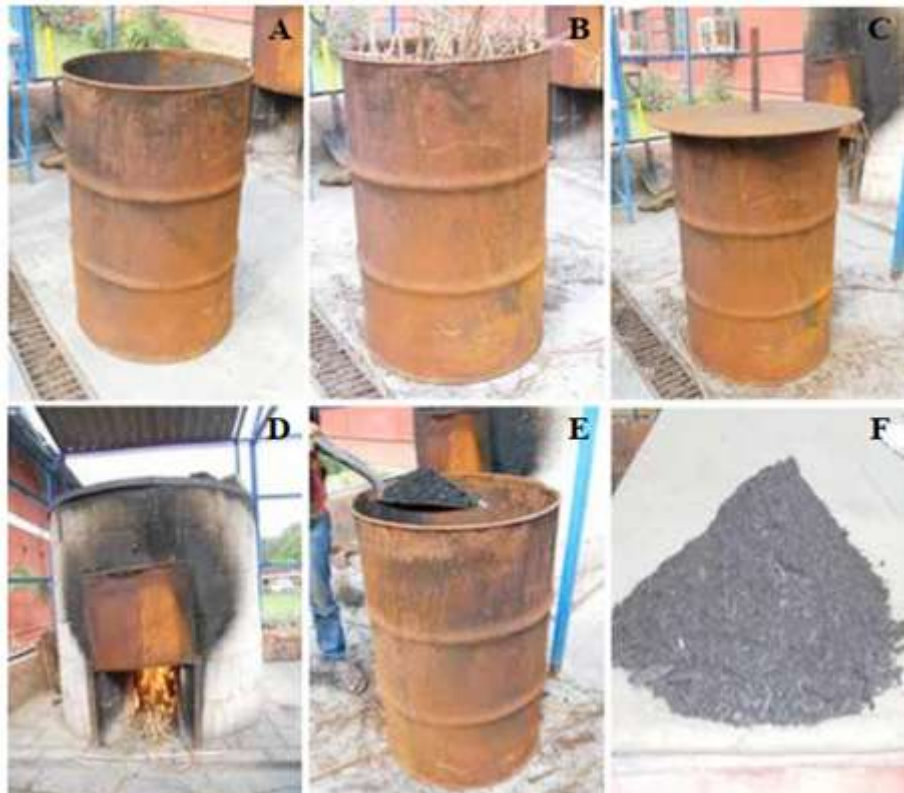
Hình 3. Quá trình tạo than sinh học bằng phương pháp thùng phuy
