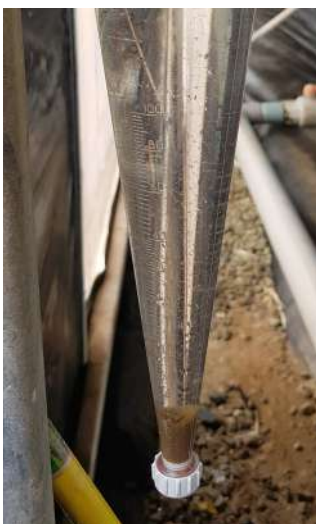
Hình 1. Dụng cụ đo thể tích Biofloc (đáy phễu)
