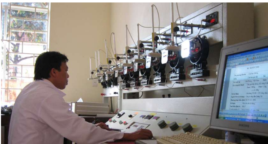
Kiểm định phương tiện đo tại Trung tâm Kỹ thuật Tiêu chuẩn Đo lường Chất lượng. Ảnh: Tư liệu.
