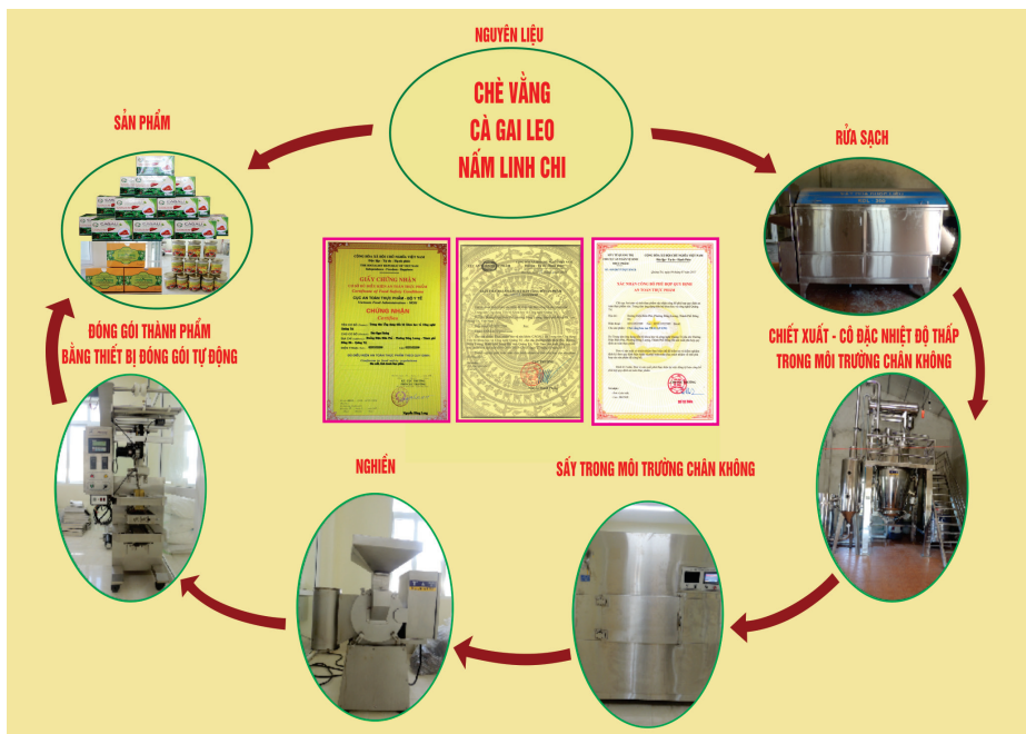
Quy trình sản xuất các sản phẩm trà hòa tan Tralavang, Cà gai leo - Linh chi, ... Ảnh: Thái Sơn
