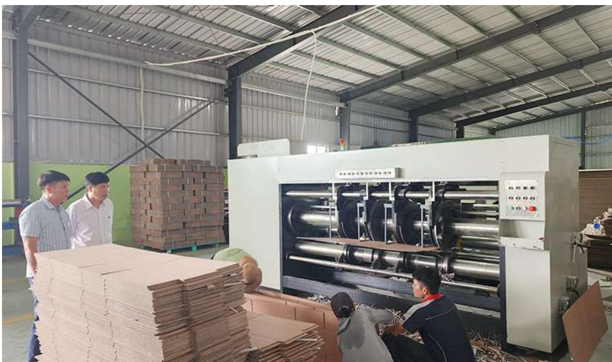
Hệ thống dây chuyền sản xuất carton sóng 7 lớp tại nhà máy sản xuất bao bì carton Quảng Trị. Dự án thuộc chính sách hỗ trợ ứng dụng, nhân rộng các kết quả KH&CN trên địa bàn tỉnh theo Nghị quyết số 163/2021/NQ-HĐND của Hội đồng nhân dân tỉnh Quảng Trị, thực hiện năm 2023. Ảnh: Tư Liệu.
