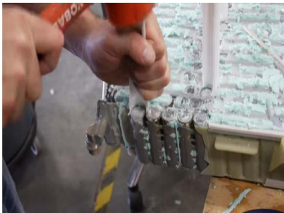
Hình 2. Tháo dỡ bộ ắc quy - Vật liệu nhựa nhiệt
